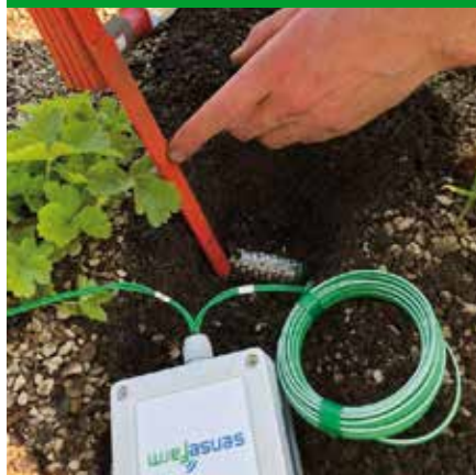
Monteringsdjup på markfuktssensor. Sam Madsen förbereder nedgrävning. Torun Jorde.
